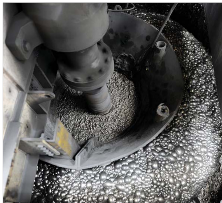
Флотационната машина работи като пералня - с реагенти, вода и въздух тя извлича минералите, които съдържат злато, сребро и мед.
