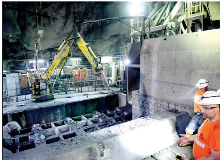
Хидравличен чука троши извънгабаритните скални късове.
