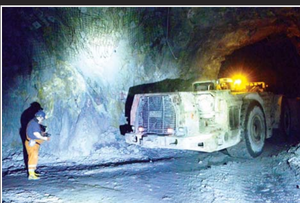
Оператор на челен товарач управлява машината дистанционно. Ако вратата ѝ не е плътно затворената, тя отказва да работи.
