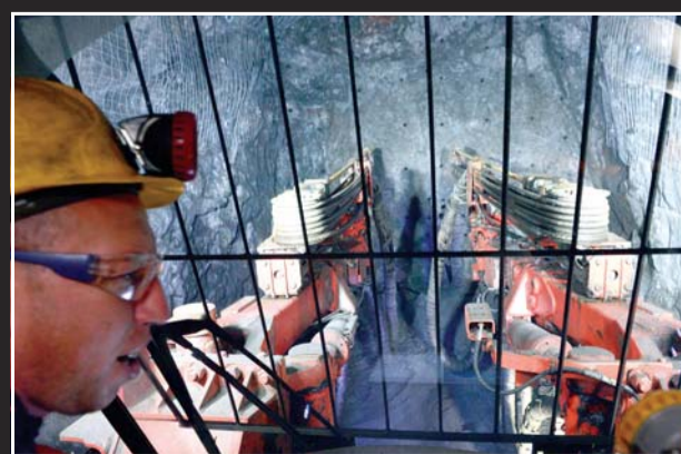
Операторите на пробивна карета работят по предварително разчертани схеми. Така знаят къде и на каква дълбочина да направят пробивите в скалата.
